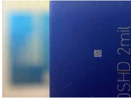
向上调节液态镜头可聚焦较小的数据矩阵码特写，向下调节可聚焦到远距离处的条码。
