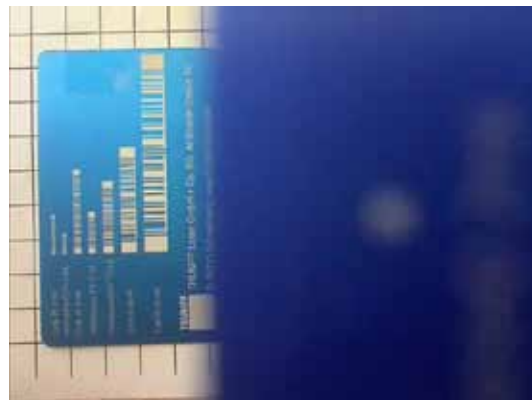
向上调节液态镜头可聚焦较小的数据矩阵码特写，向下调节可聚焦到远距离处的条码。
